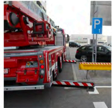
Area de estabilización .
