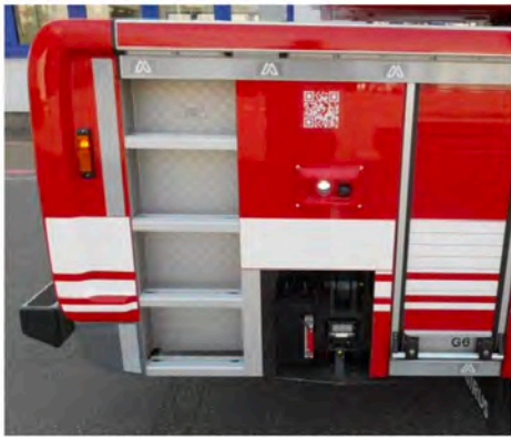
Camara con luz led sobre el estabilizador.
