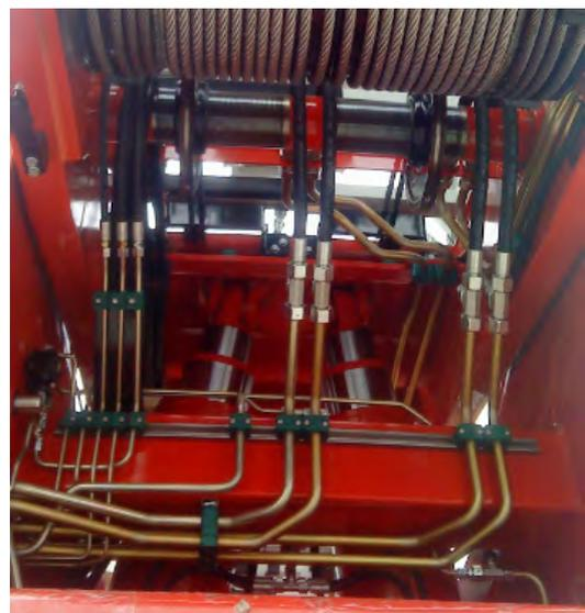
Posee un sistema de control de presión de aceite a través del pedal de hombre muerto donde al accionar el pedal el sistema se presuriza de manera correcta y lo indica con una alerta en el panel del operado.
