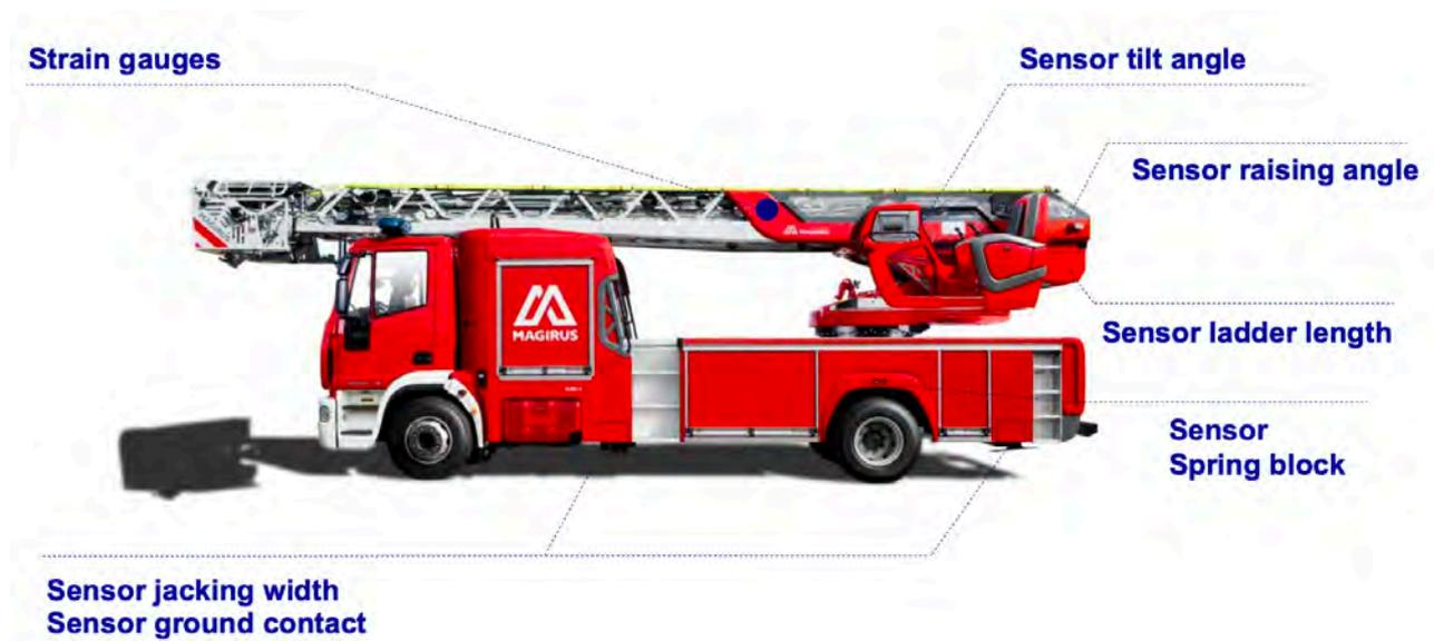
Un sensor en el perfil de la escalera mide la carga de tracción y las tensiones de compresión y proporciona datos para la flexión y, por lo tanto, el par de carga.
