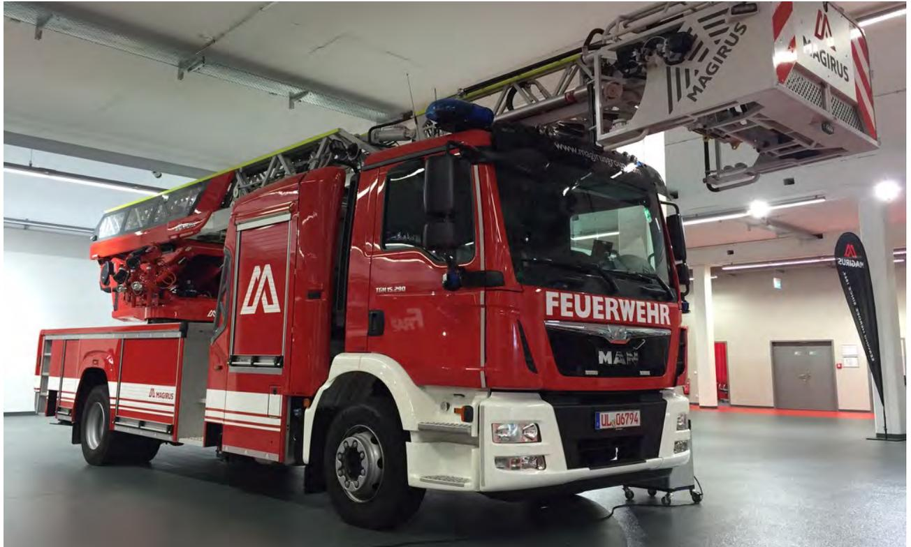
4.1.1 Cabina SIMPLE original del fabricante del chasis. Esta permite el correcto acceso al motor, caja de velocidades y otros componentes. La cabina es abatible y cuenta con dispositivo de seguridad de cada accidental.
