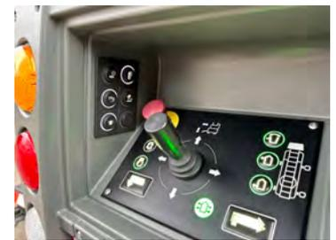
Sistema de accionamiento mecánico-Hidráulico que bloquea la suspensión del eje trasero, mediante compresión del conjunto de ballestas transformando al conjunto en una estructura rígida. Posee alarmas sonoras y luminosas en caso de liberación del freno de parking.
