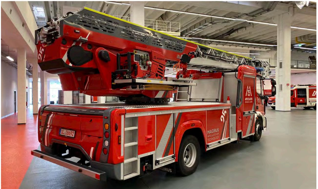
El esqueleto y estructura se construye en forma modular a base de perfiles especiales atornillados de **aluminio reforzado "AluFire"** de máxima estabilidad y duración en conjunto con barras atravesadas de acero de alto grado. Los perfiles son bañados con método catódico y pintado con varias capas.
