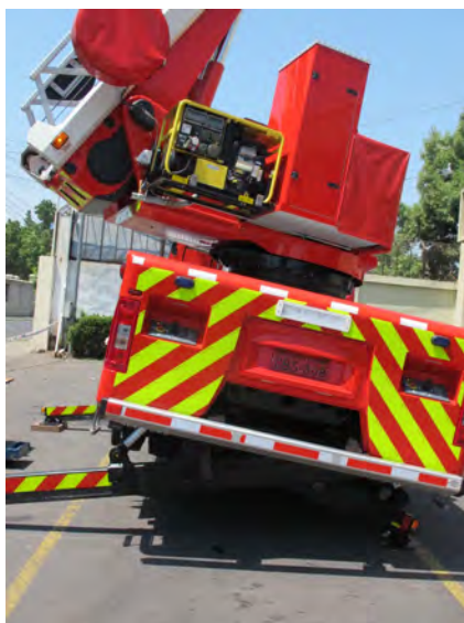
Ejemplo estabilización extrema con nivelación de la tornameasa
