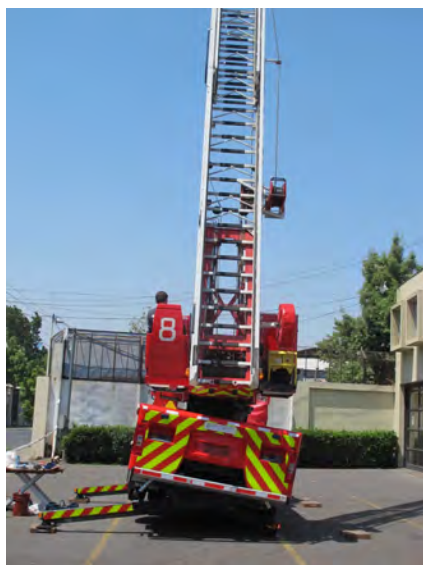
Ejemplo estabilización extrema con nivelación de la tornameasa
