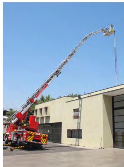
Ejemplo estabilización extrema con nivelación de la tornameasa
