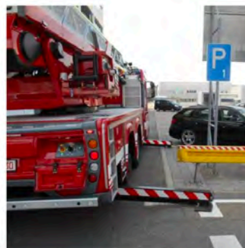
Area de estabilización .
