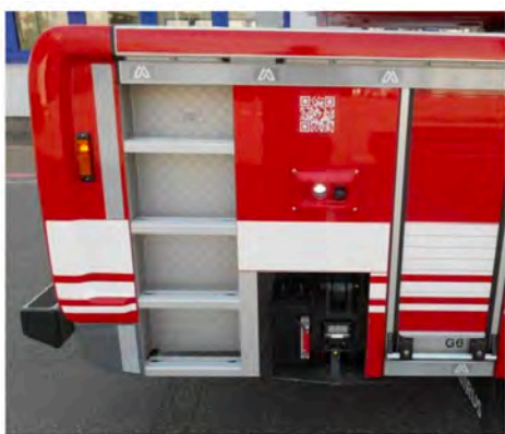
Camara con luz led sobre el estabilizador.
