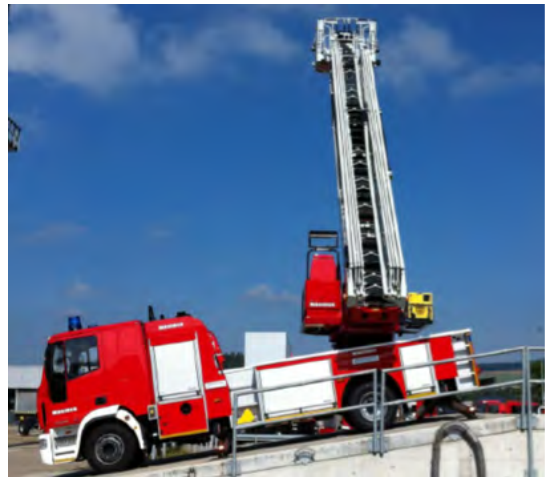
Ejemplo de nivelación de la tornamesa
