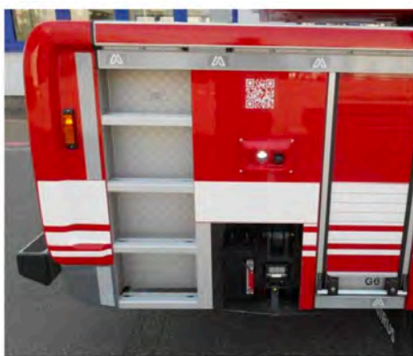
Camara con luz led sobre el estabilizador.
