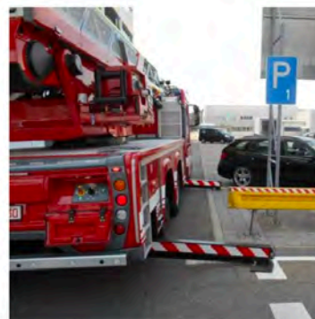
Area de estabilización .
