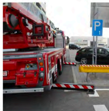
Area de estabilización .
