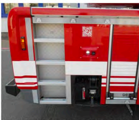
Camara con luz led sobre el estabilizador.
